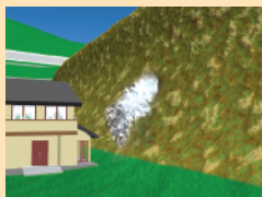
斜面から水が噴き出す
